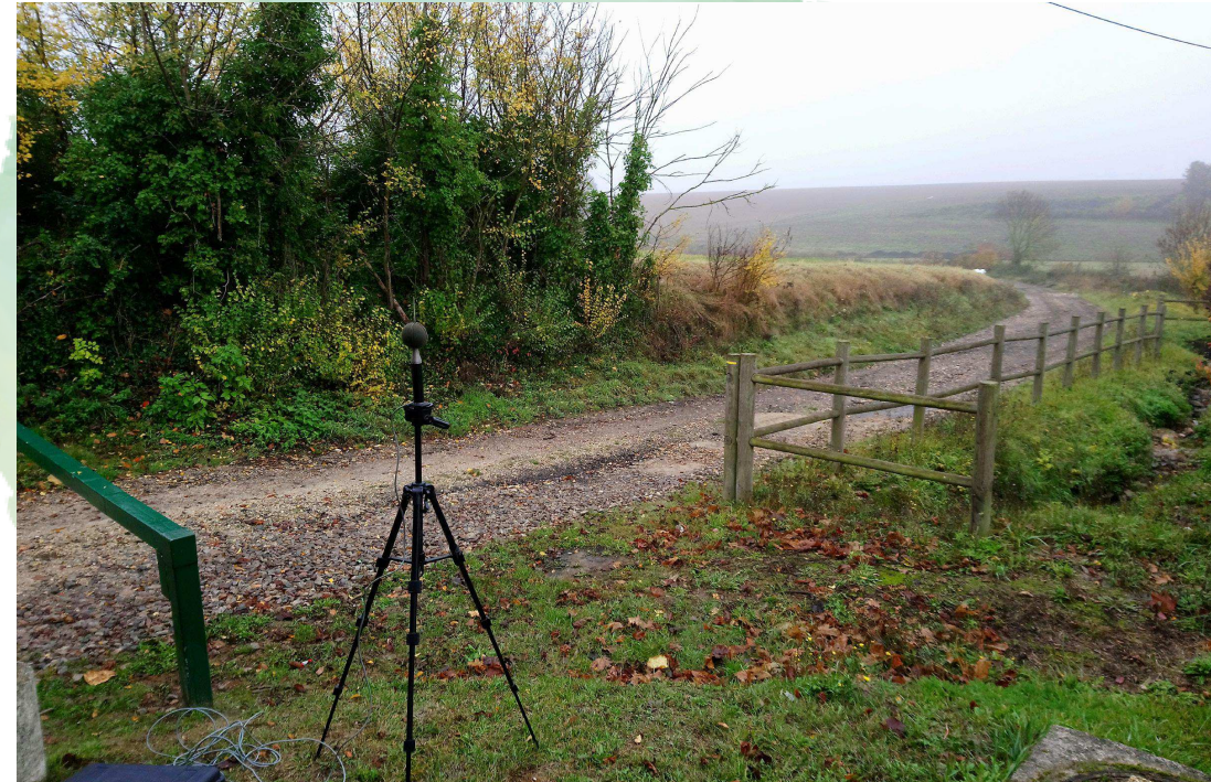
Photo 2 : Sonomètre lors des mesures acoustiques près des habitations de Bouqueval.
